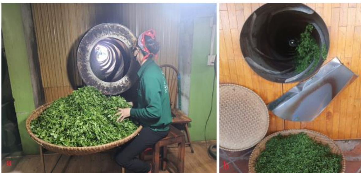
Hình 3. 14. Ống làm héo chè liên hoàn (a: đầu cho chè tươi vào; b: đầu ra chè héo)
