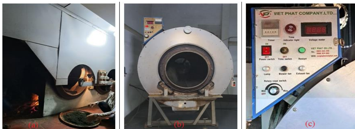
Hình 3. 15. Các loại tôn sao chè (a: tôn sao bằng củi; b: tôn sao bằng gas, c: thiết bị điều khiển nhiệt độ thời gian của tôn sao bằng gas)
