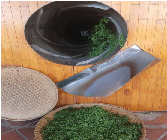
Hình 1. 10. Chè làm héo cường bức, diệt men bằng ống sao chè liên hoàn
